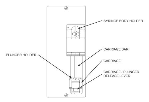
Figure 10. Heparin Pump Module.
